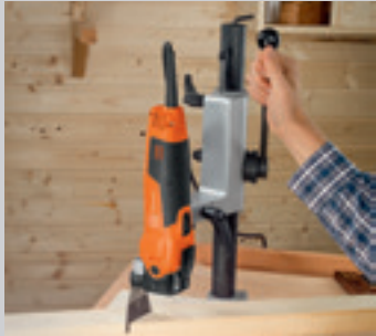
Kan kombineras med ett borrarstativ för millimeterexakt frammatning.
